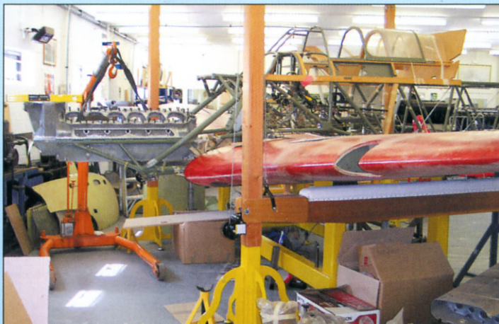
Як-1 в процессе восстановления. Двигатель М-105 Як-1 №1342. Фотографии Гай Блэк (Guy Black).
