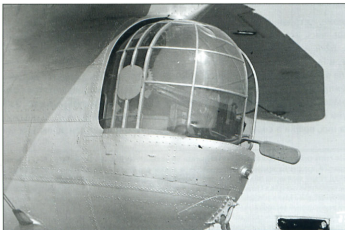
Кормовая оборонительная установка МТБ-2Д. Пушка заменена аэродинамически-подобным макетом.
