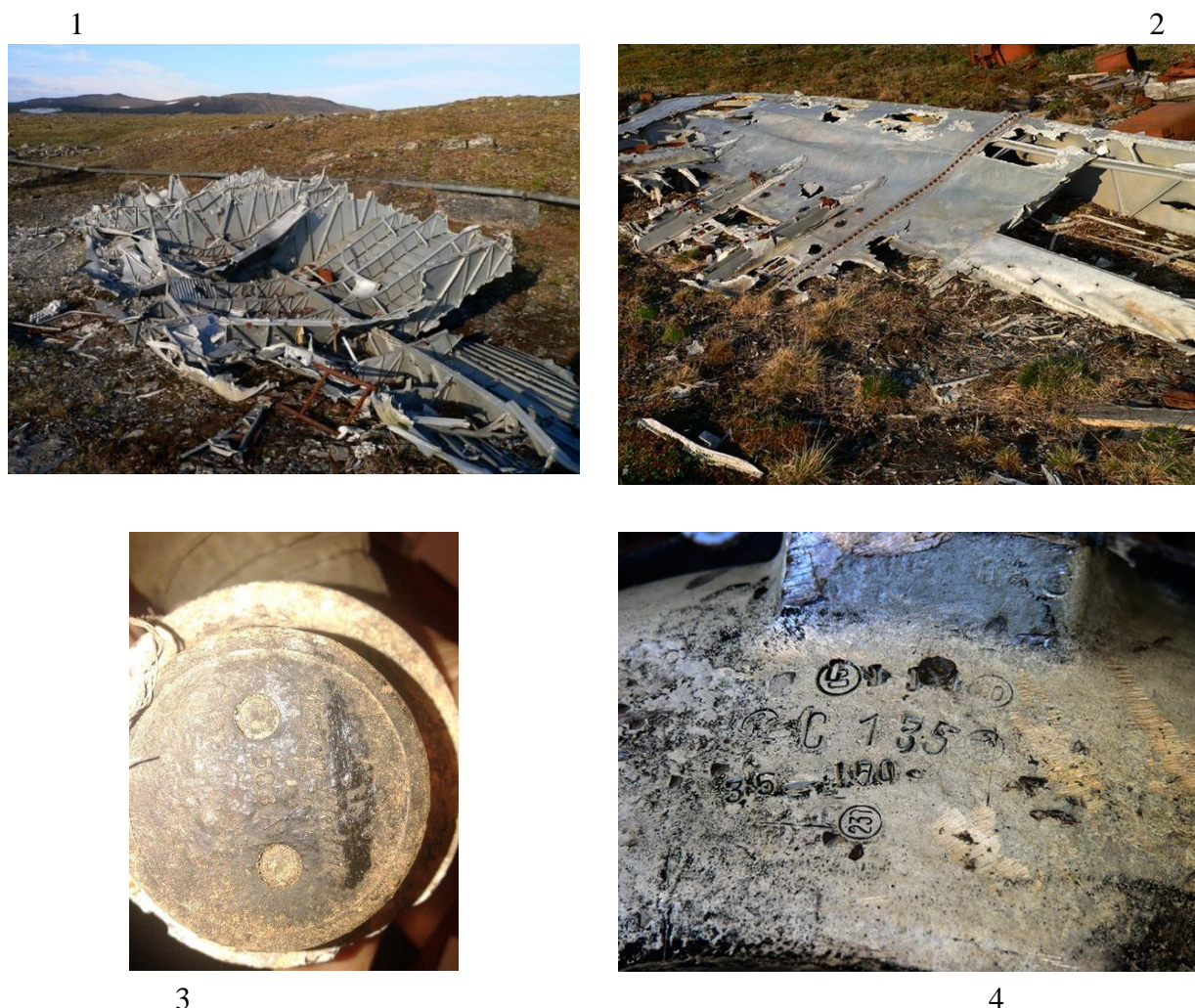
Рис. 2 – Остатки гидросамолета «Каталина»: 1 – остов фюзеляжа, 2 – крыло, 3 – наушник, 4 – части двигателя «Pratt & Whitney R-1830-58»
