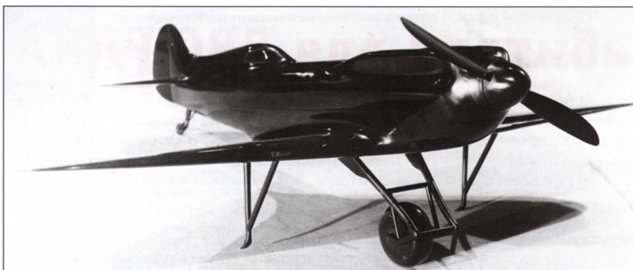
Продувочная модель истребителя Г-26
