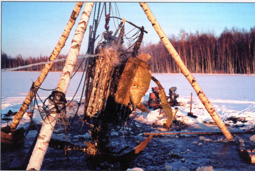
Подъем двигателя АМ-38 из воды при помощи подручных средств
