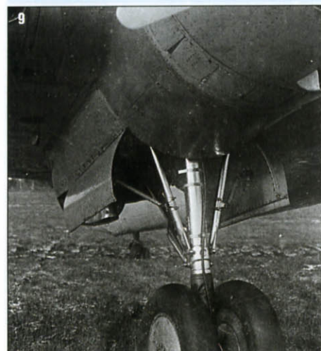
9. Вид на моторную гондолу и правую стойку шасси.
