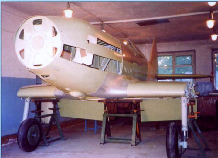
Еще один МиГ-3 готовится к полетам! Самолет изготавливается в Новосибирске организацией ООО «РБ Авион» по заказу иностранного заказчика. Этот экземпляр, также и как МиГ-3, восстановленный компанией «Авиареставрация» (о нем мы подробно рассказали в «Крылья» №2 2008), предполагается оснастить американским двигателем «Алиссон». Фотографии предоставлены М. Государкиным.
