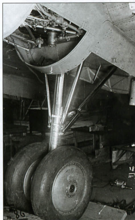
Левая основная стойка шасси с вильчатым задним подкосом.
