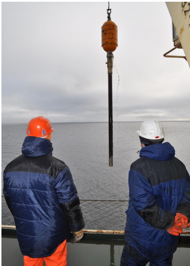
Рис.1. Подъем гидростатической трубки в районе острова Генриетта
