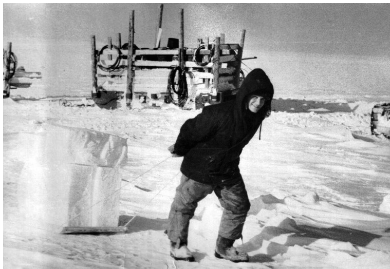
Фото 7. На заднем плане грузовые сани с вертикальными стойками. Предназначены для перевозки ГСМ в бочках. Можно загружать в два яруса, разделяя сепарацией из досок. Помещается 50 бочек. Общий вес с саними составляет 13–14 тонн.
