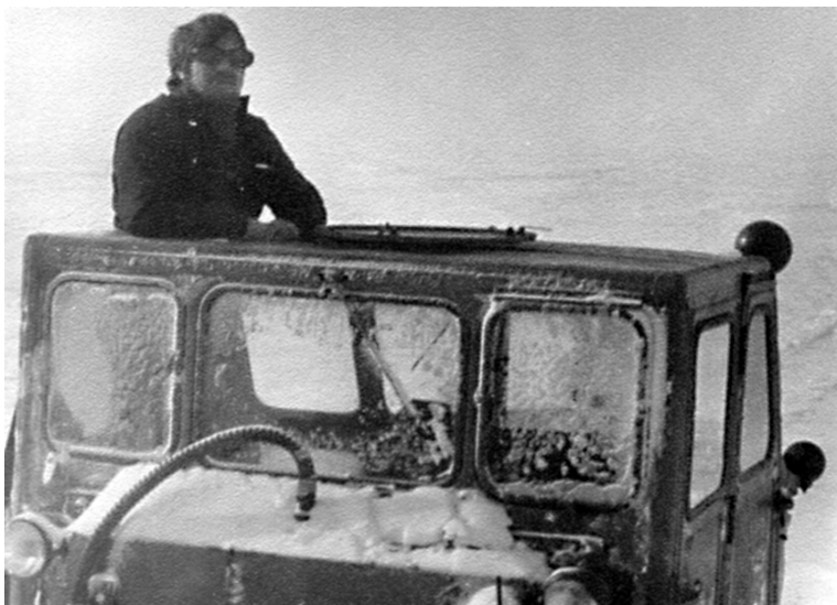
Фото 8. В крышу трактора Т-100 «врезан» аварийный люк, что являлось обязательным условием оборудования тракторов, работавших в экспедициях на ледовом припае.
