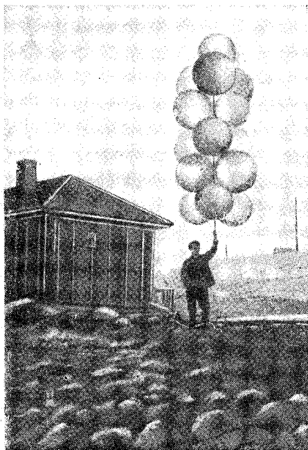
Способ связки шаров для подъема радиозонда (слева). Разборка ветродвигателя в бухте Тихой (справа)
