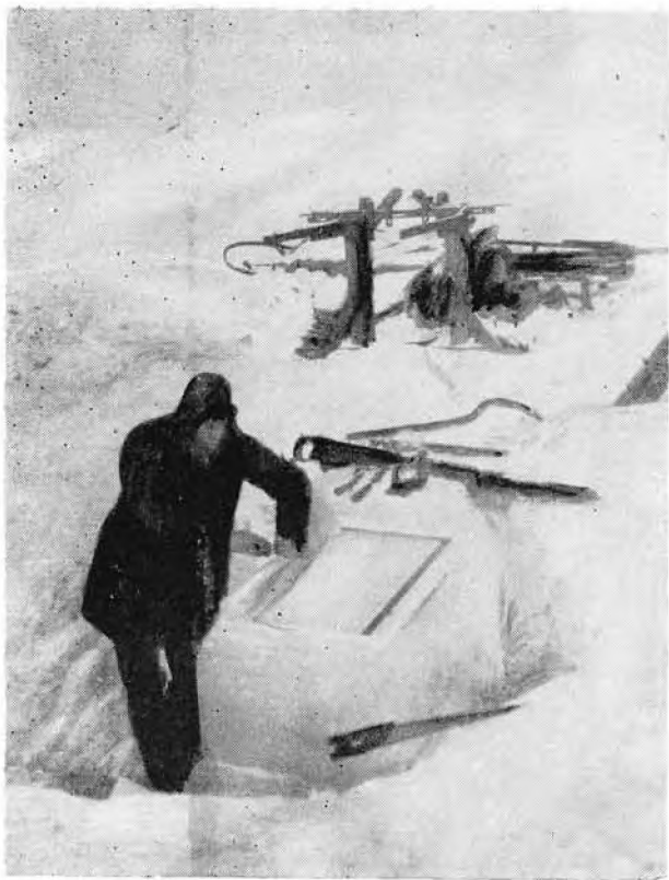
Изготовление образцов льда непосредственно из ледяного массива.
