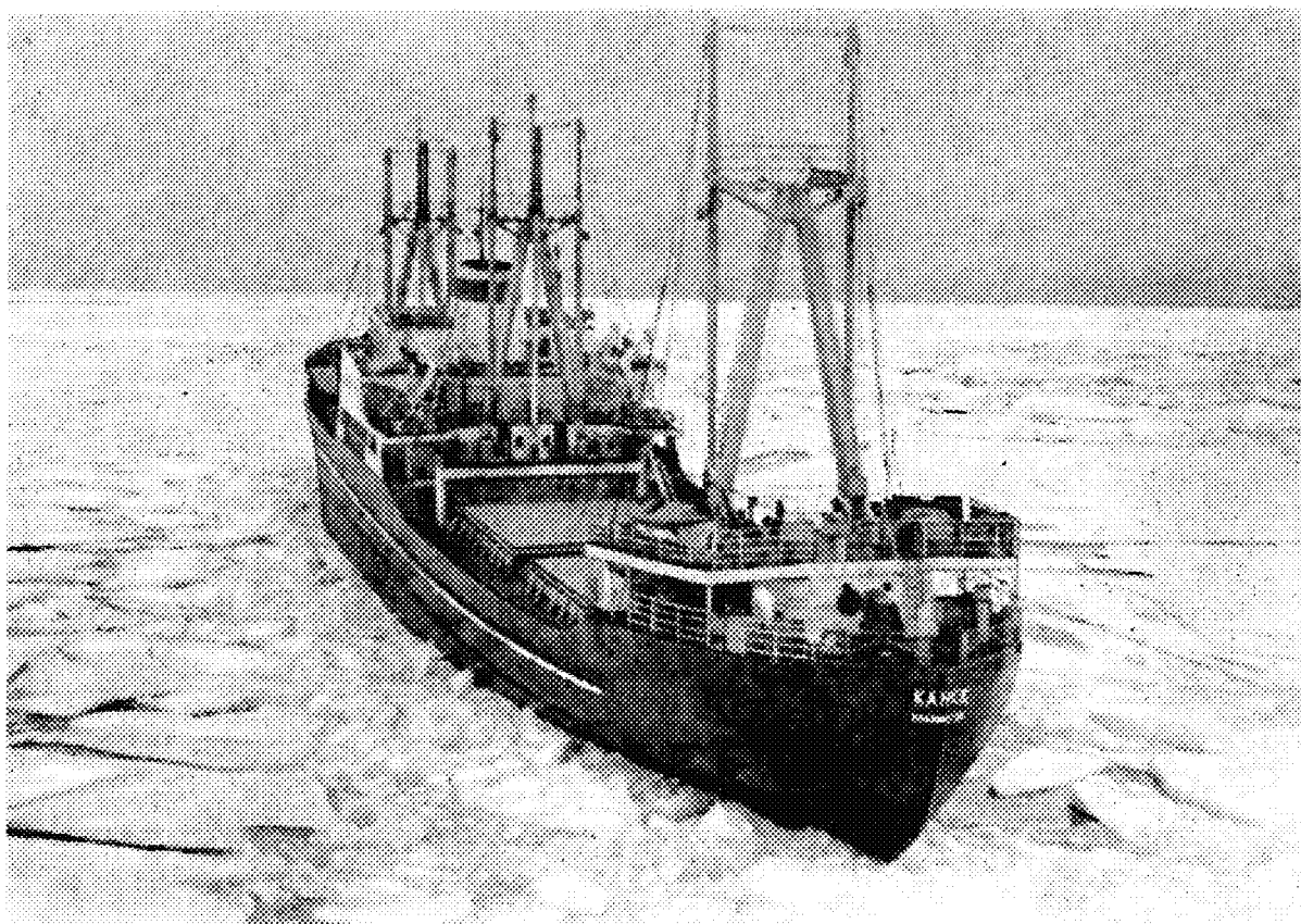
Рис. 63. Сжатый лед. Канал за судном закрыт, тертый лед набит в плотный слой, на стыке полей видны свежие торосы.
