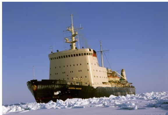
Рис. 6.27 Дизель-электроход ледокол Адмирал Макаров . Судно типа Ермак (1974–1976), к которому относятся также ледокол Красин . Построено в 1975 году в Финляндии. В настоящее время в составе флота FESCO. Печатается с разрешения ОАО «Дальневосточное морское пароходство»
