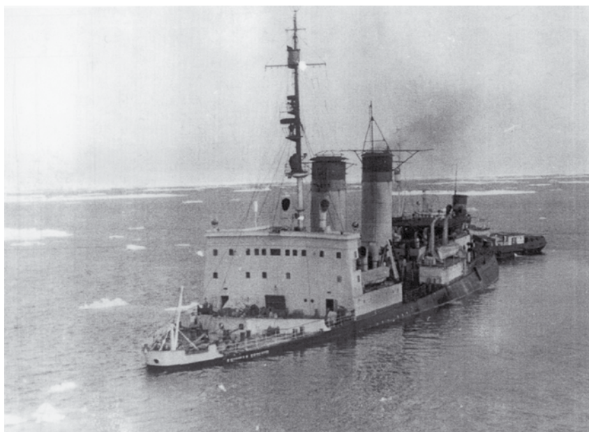
Рис. 5.19 Ледокол Адмирал Лазарев . Несколько сантиметров до затопления палубы. Печатается с разрешения ОАО «Дальневосточное морское пароходство»
