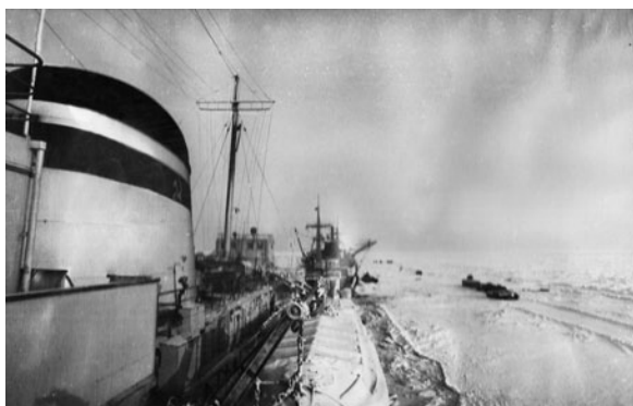
Рис. 3.8 Установка судна в припай. Ледокол Мурманск корма в корме «впечатывает» в лед грузовое судно Павел Пономарев . Фото Г.Д. Буркова из личного архива печатается с его разрешения
