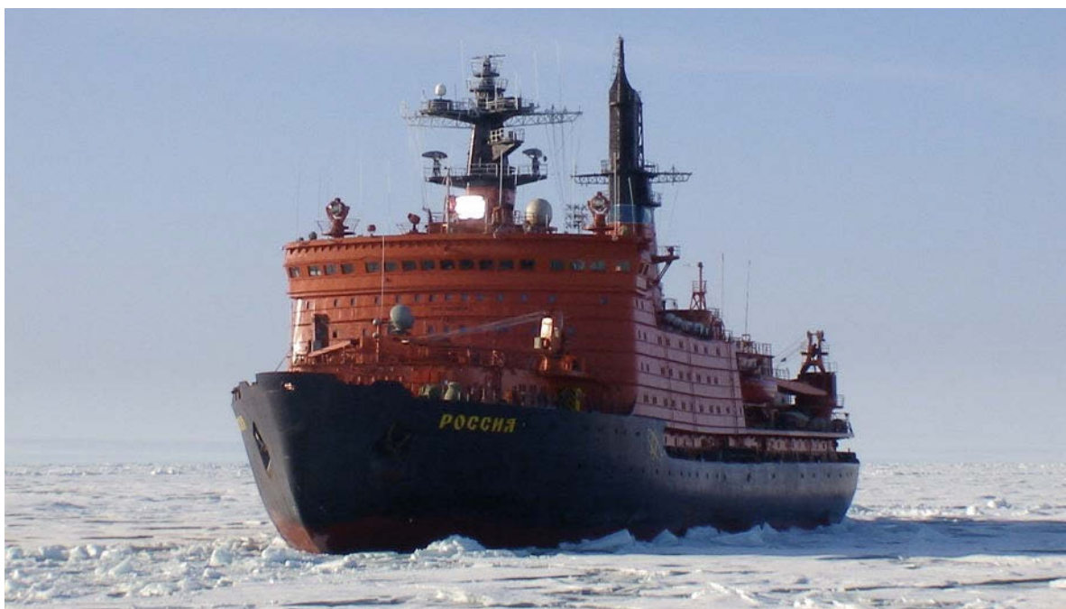
Рис. 2.3 Атомный ледокол Россия . Ледокол типа «Арктика», заложен 20 февраля 1981 года на Балтийском заводе им. Серго Орджоникидзе в Ленинграде спущен на воду 2 ноября 1983 года, принят в эксплуатацию 21 декабря 1985 года, является четвертым в мире ледоколом с ядерной энергетической установкой. Фото А.В. Марченко. Печатается с его разрешения
