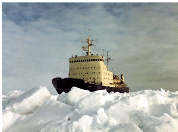
Рис. 2.2 Дизель-электроход ледокол Ермак . Головное судно серии (1974-1976 гг.), в которую вошли ледоколы Адмирал Макаров и Красин . Построен в 1974 году в Финляндии. Печатается с разрешения ОАО «Дальневосточное морское пароходство»
