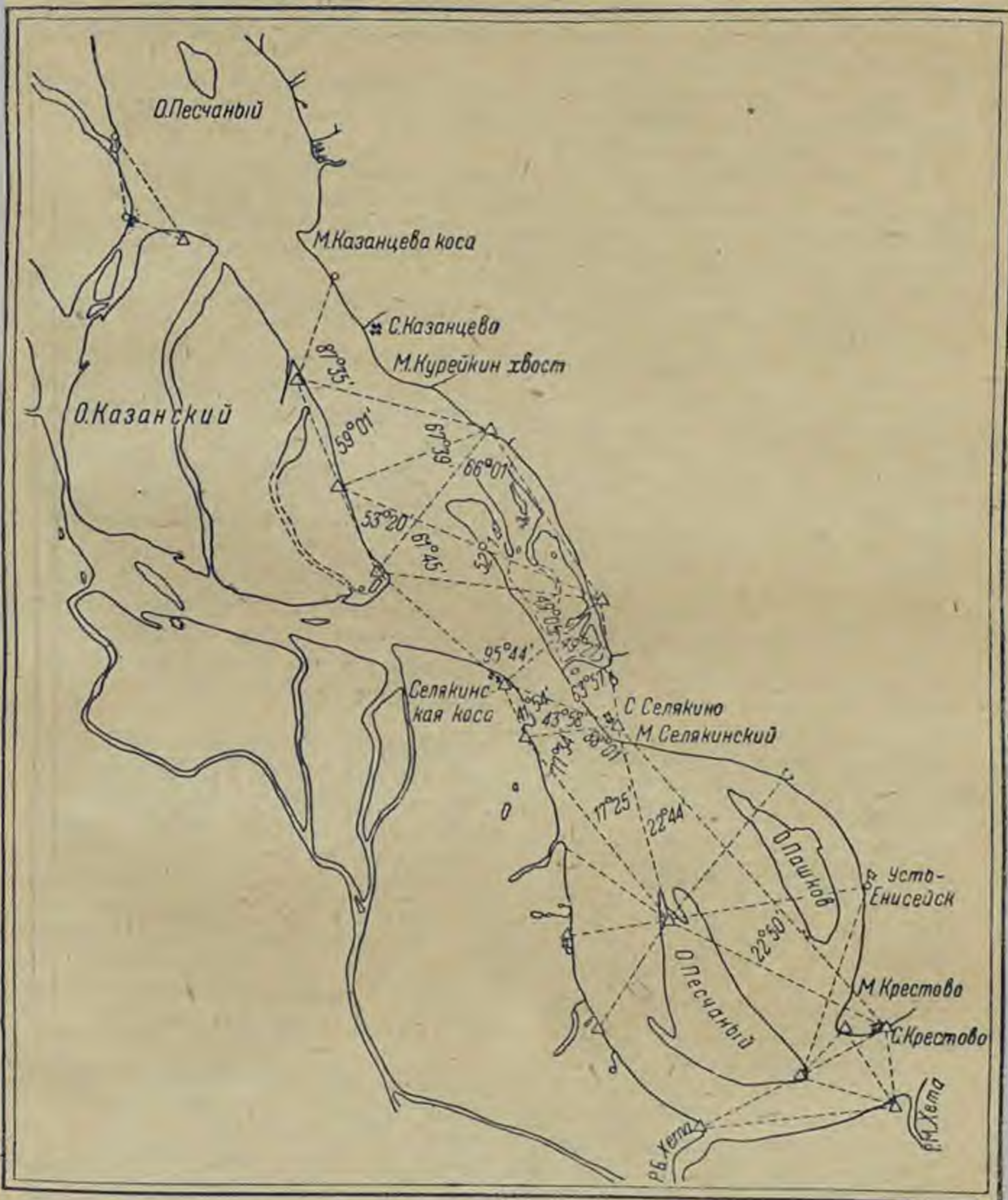
Рис. 33. Схема триангуляции, съемок и привязок от мыса Крестовского до мыса Казанцева коса (Работа Отдельного Обь-Енисейского гидрографического отряда в 1921 г.).
