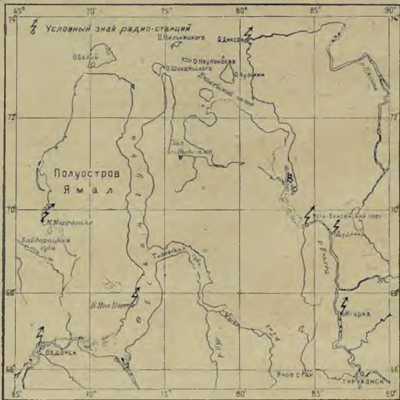
Рис. 13. Схема радиотелеграфной сети станций Убеко-Сибири.
