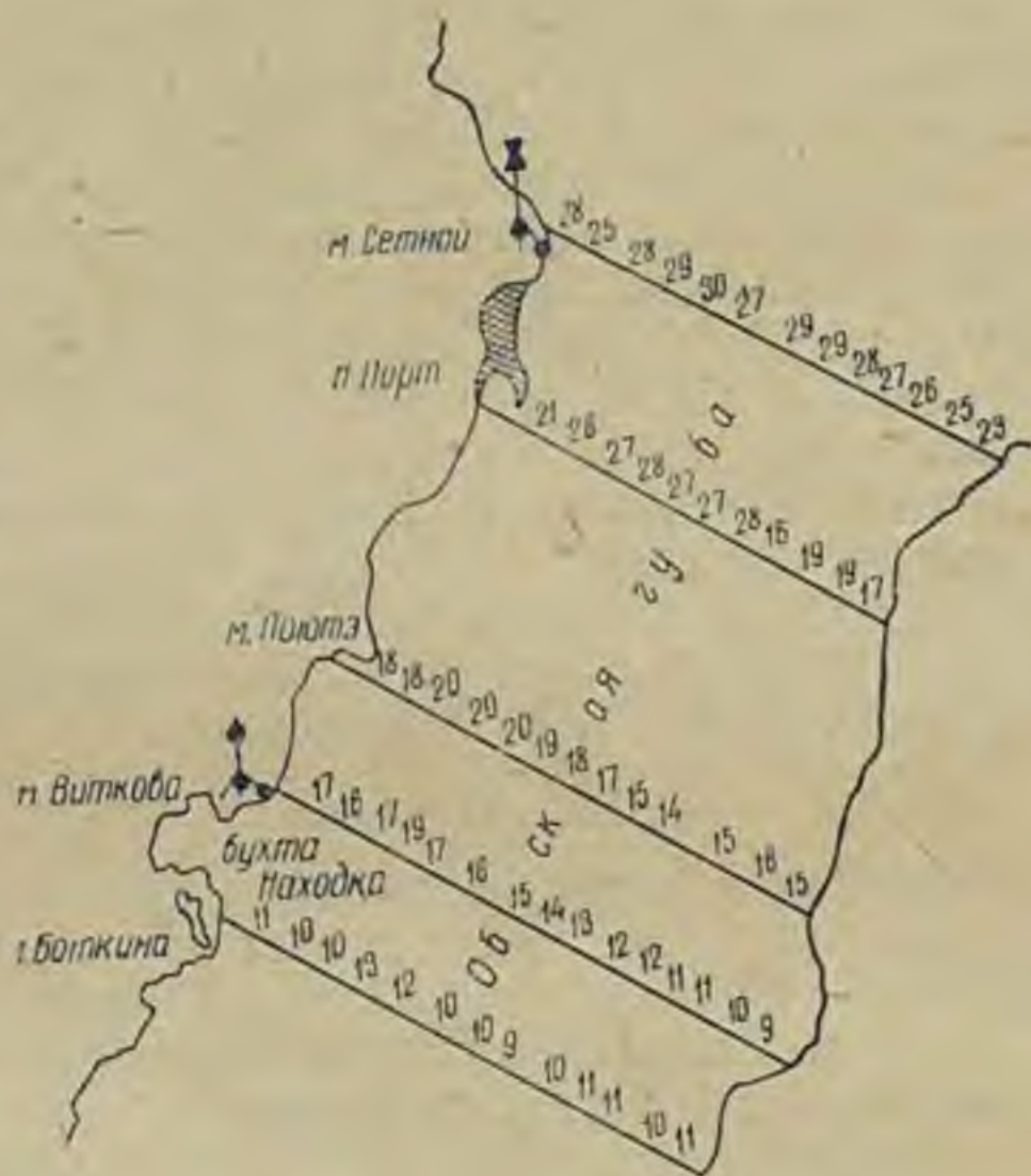
Рис. 25. Схема промера, произведенного в Обской губе.
