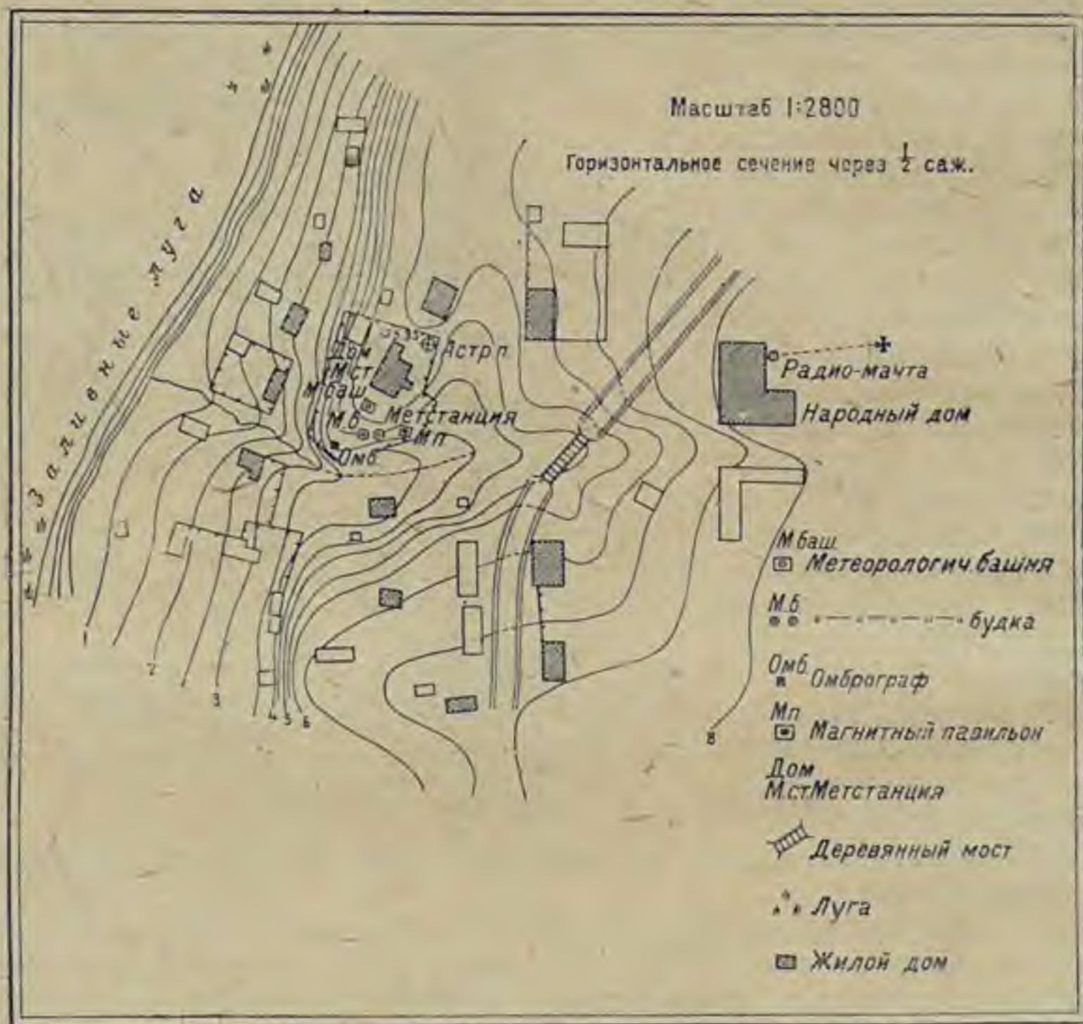
Рис. 28 План метеорологической станции Обдорска и схема расположения астрономического пункта (июль 1928 г.).
