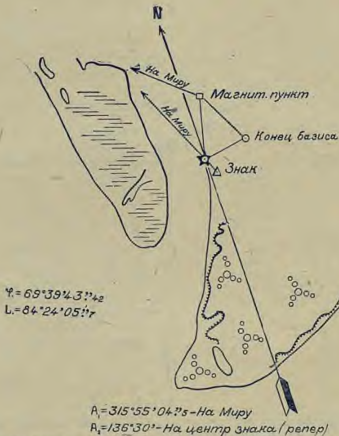
Рис. 67. Схема расположения астропункта в Усть-Енисейском порту (1927 г.).
