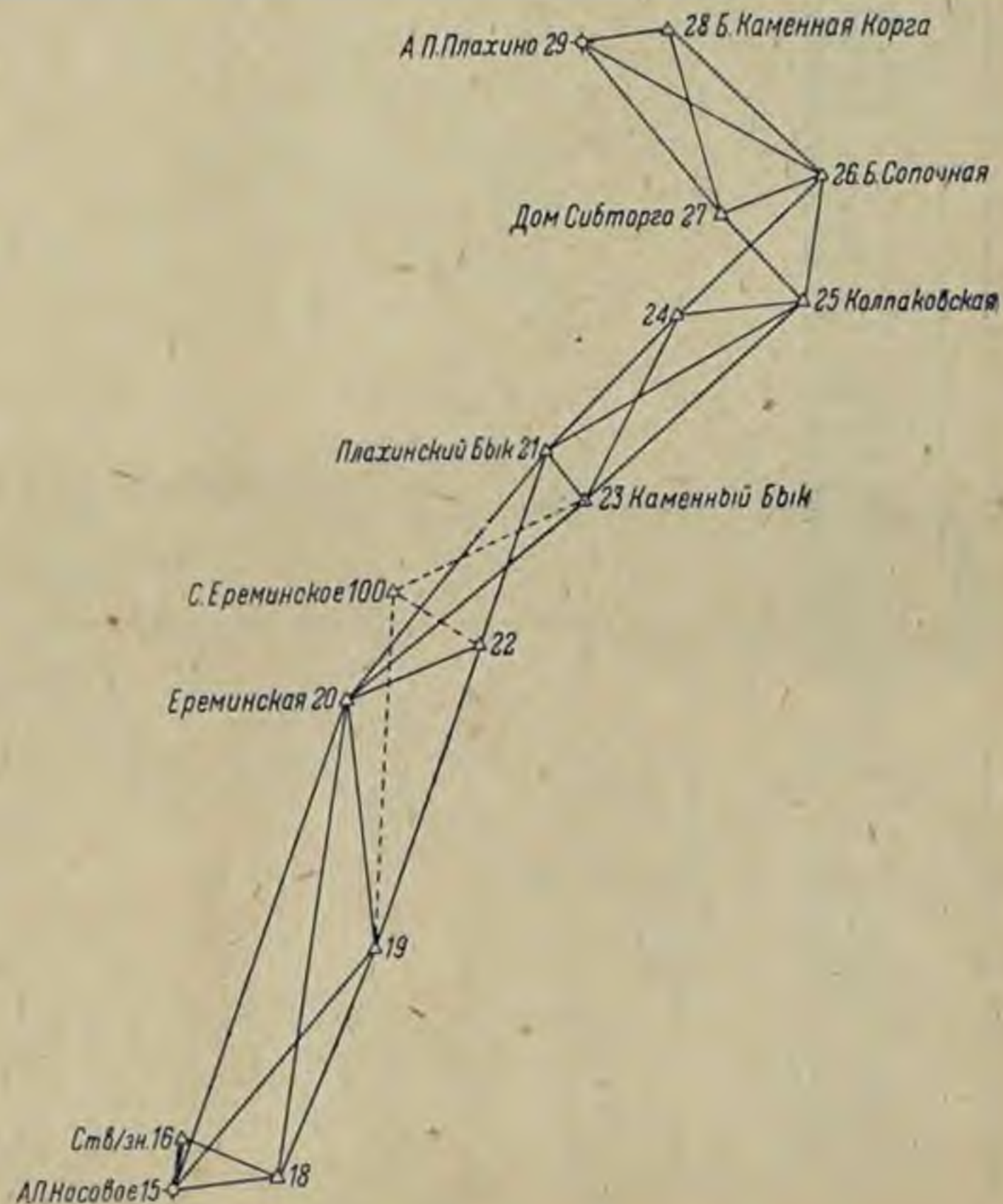
Рис. 117. Схематический чертеж триангуляции III класса, проложенной в 1932 г. Убеко-Сибири по р. Енисею; ряд Плахино — Носовое.
