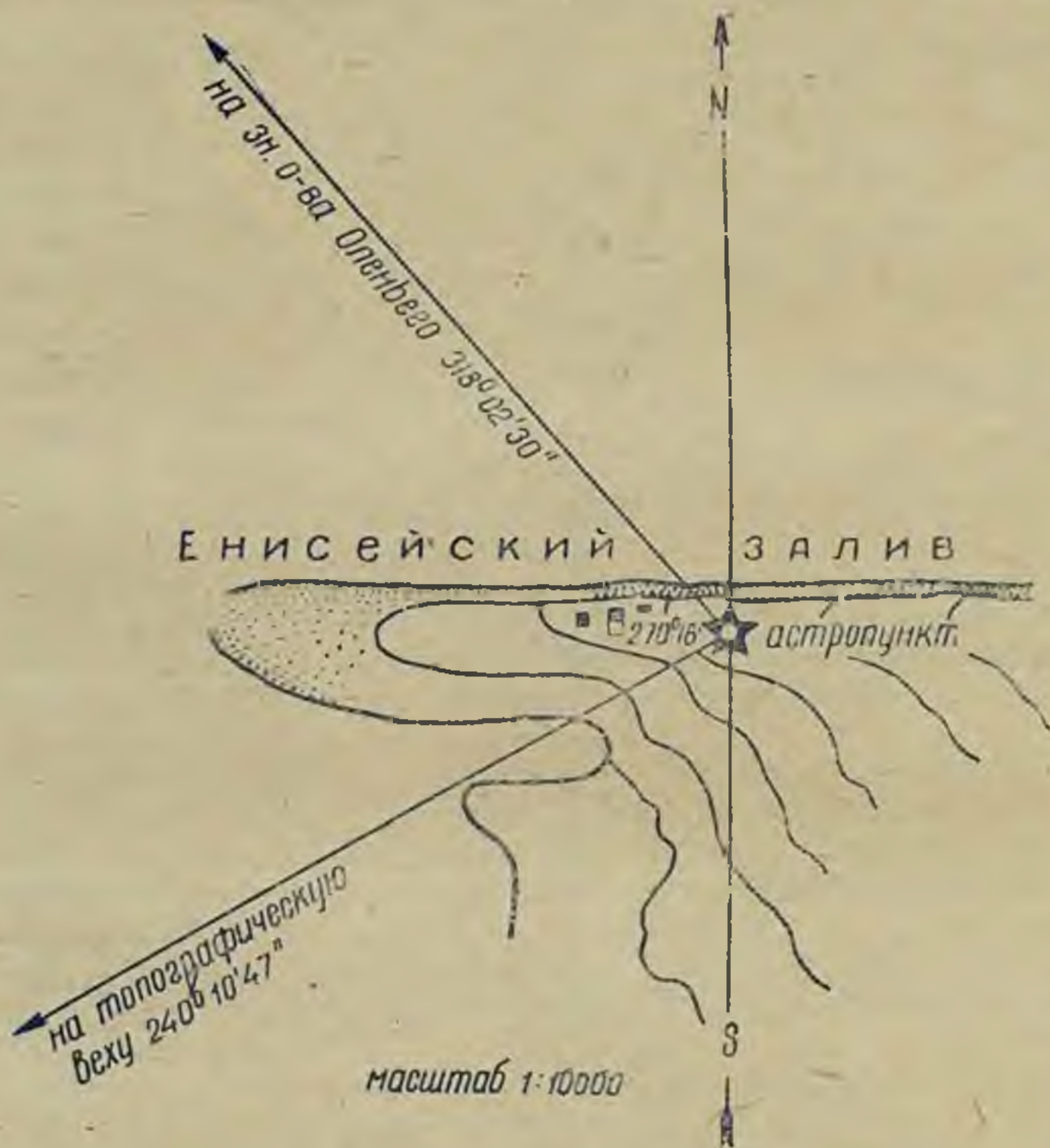
Рис. 112. Схематический план астропункта, определенного на р. Сосновой в 1932 г.
