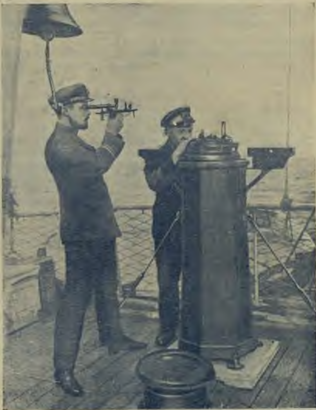
Рис. 51. Г/с „Прибой“; определение места корабля на промерном галсе.
