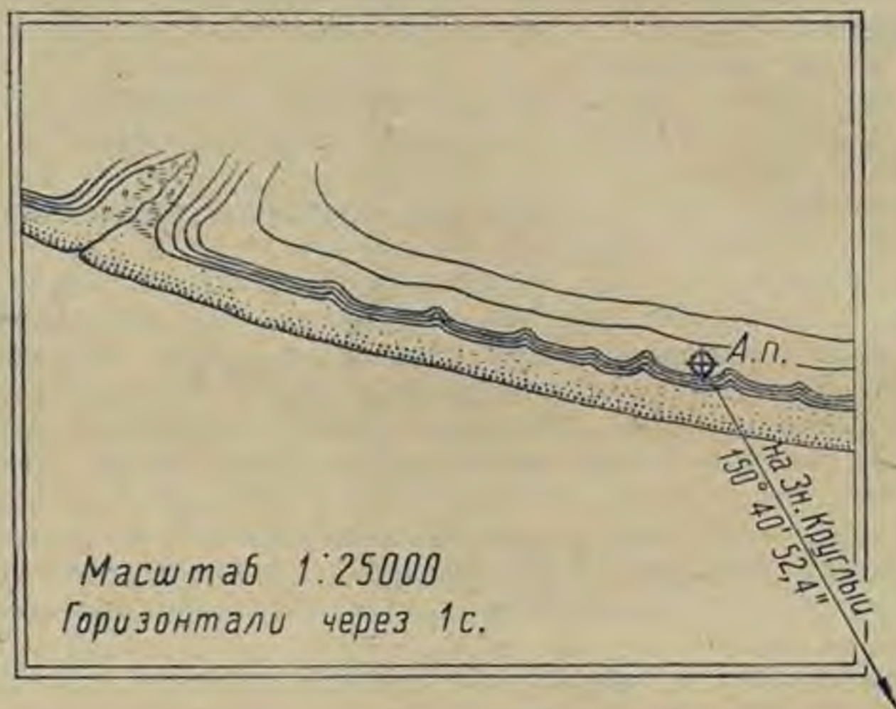
Рис. 41. План расположения астропункта Трехбугорного.
