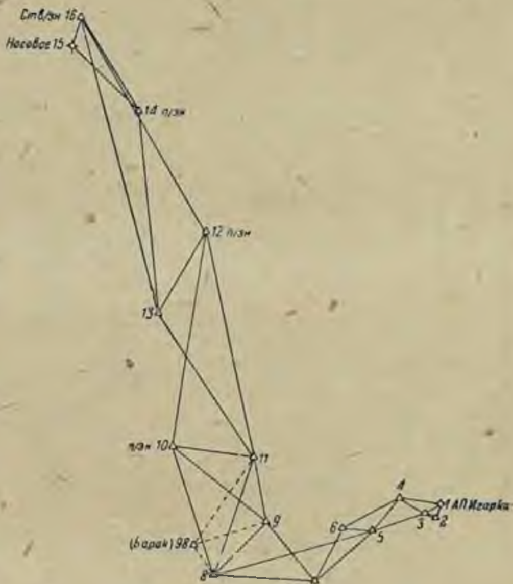
Рис. 118. Схематический чертеж триангуляции III класса, проложенной в 1932 г. Убеко-Сибири по р. Енисею; ряд Носовое — Игарка.
