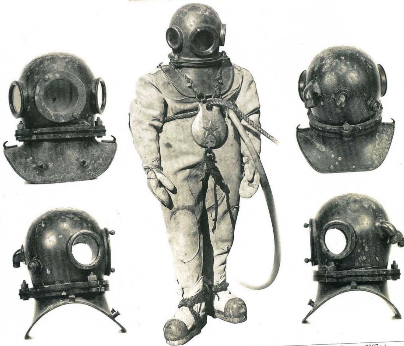
Трехболтовое вентилируемое снаряжение образца 1930-х гг. (фото конца 1930-х гг.; шлемы — фото Д. Деккера 2007 г.) Russian design threebolt «free-flow» diving gear Ш-3 (photo of end of 1930s, helmets — by David Dekker, 2007)
