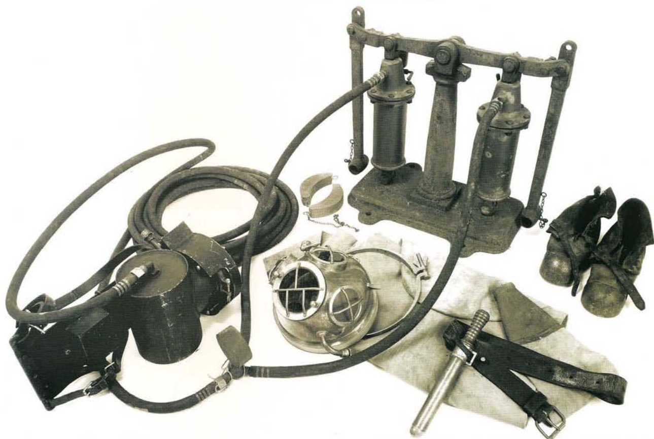
Стандартная комплектация водолазного снаряжения Денейруза образца 1865 г. «Свиное рыло» (фото Д. Деккера, 2007 г.)
