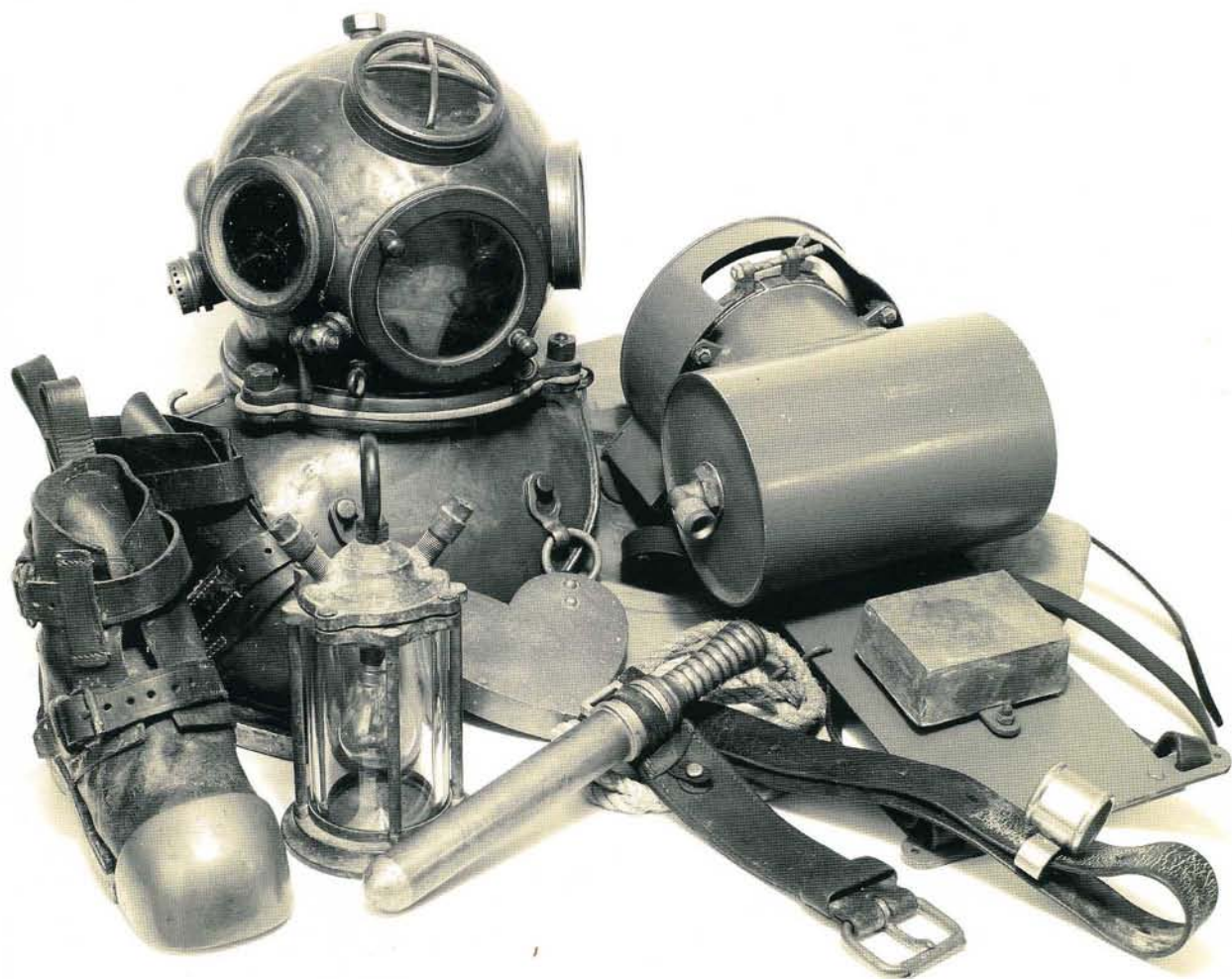
Стандартная комплектация вентилируемого трехболтового водолазного снаряжения Денейруза образца 1872 г. (фото Д. Деккера 2007 г.) A standart set of Denayrouze diving gear 1872 model (photo by David Dekker, 2007)
