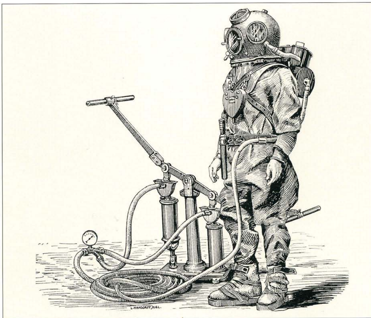
Водолазное снаряжение Денейруза образца 1872 г. (гравюра середины 1880-х гг.)
