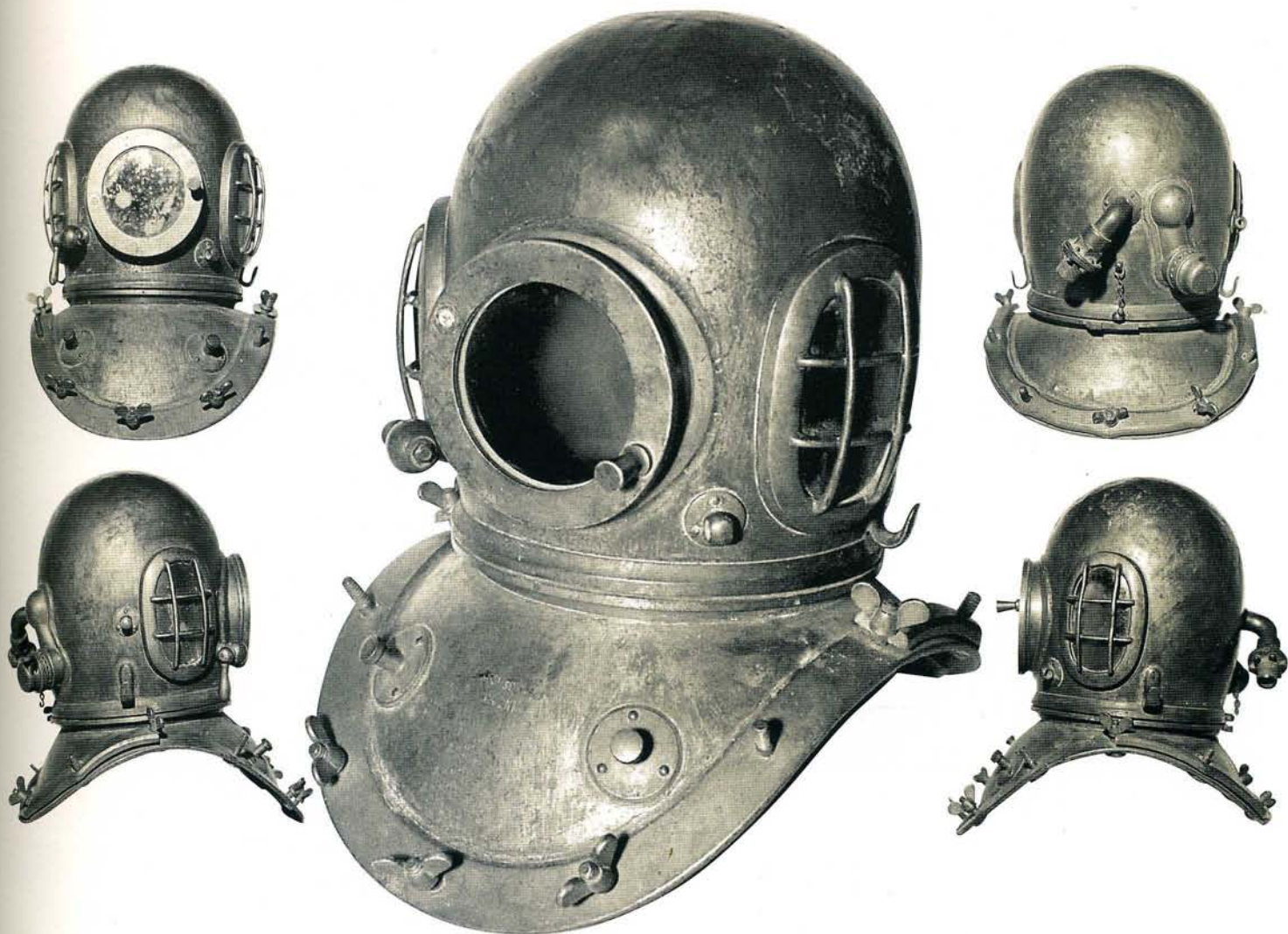
Шлем двенадцатиболтового снаряжения Зибе–Гормана выпуска 1870-х гг. (из фондов ЦВММ, фото А. Аристархова, 2006 г.)
