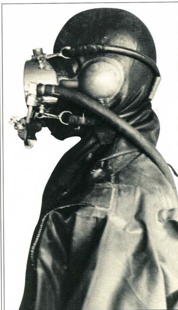
Рейдовая маска и облегченное водолазное снаряжение ОВС (фото середины 1930-х гг.)
