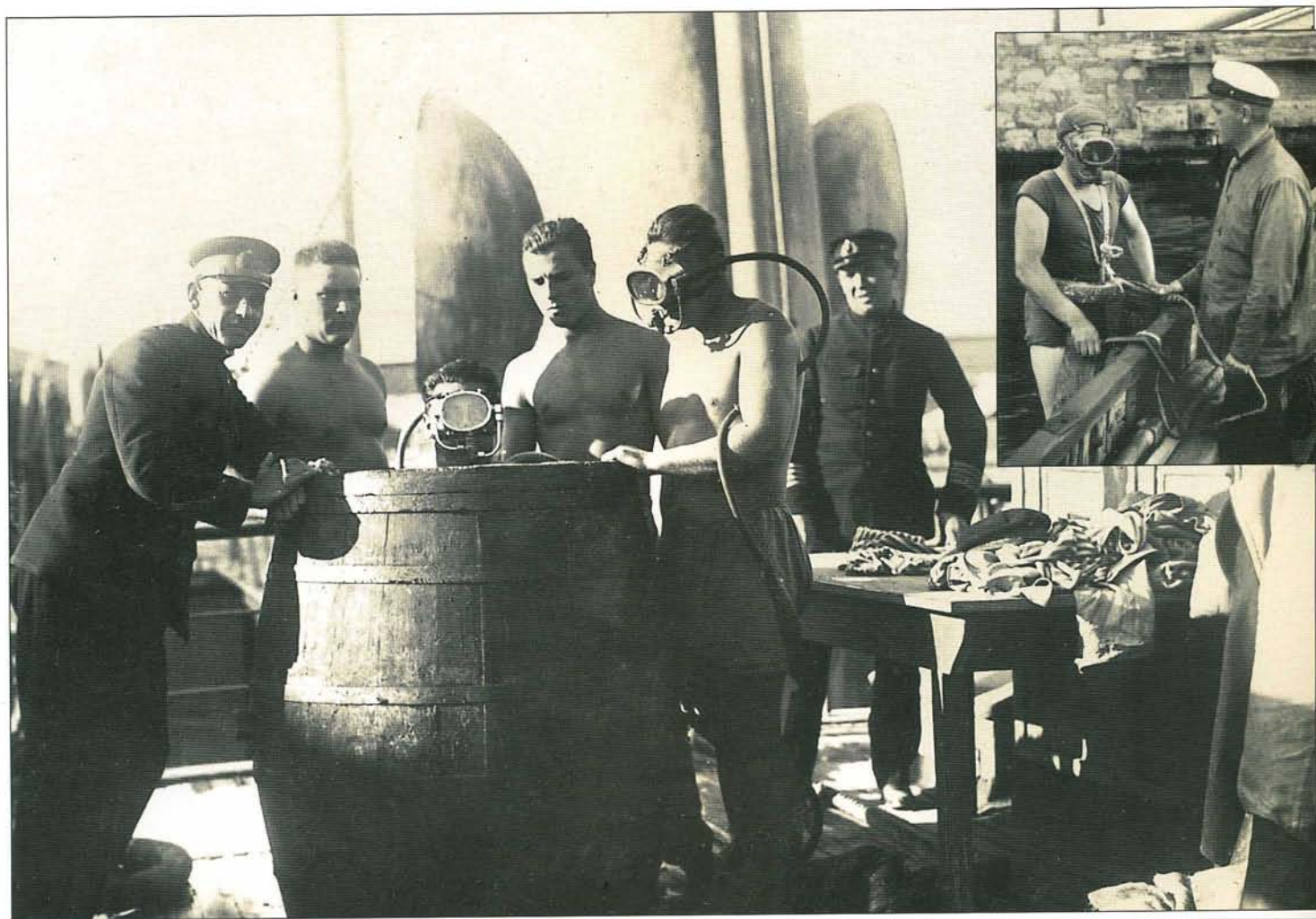
Рейдовая маска разработки инженеров ЭПРОНа (фото конца 1920-х гг.)
