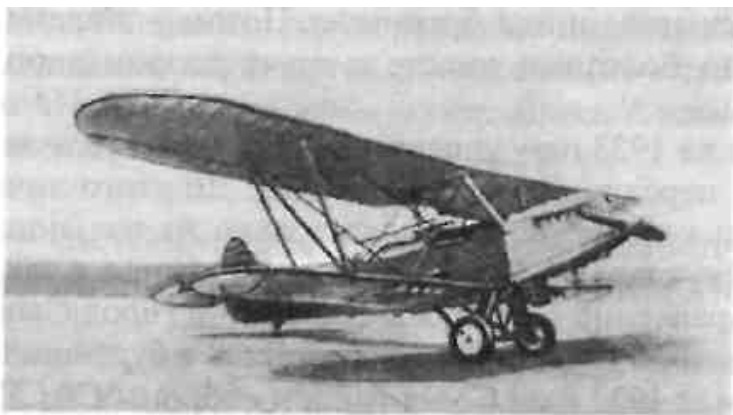
Самолет-разведчик Р-5 — двухместный классический полутораяплан конструкции Николая Поликарпова, применялся на рекогносцировке трассы БАМа. Во время войны Р-5 использовался преимущественно для воздушной разведки и транспортных перевозок
