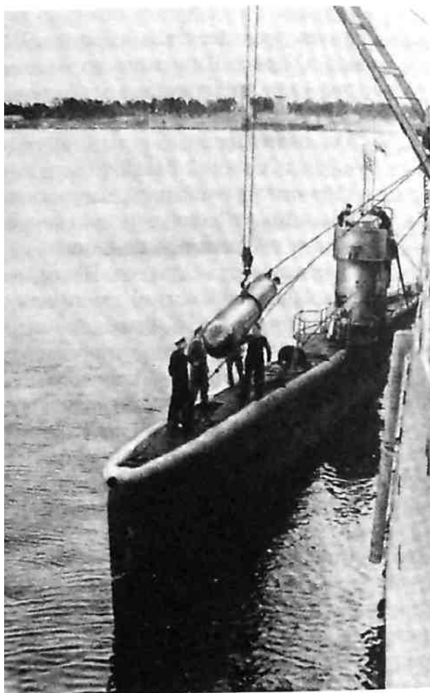
Погрузка торпед на подводную лодку типа М — «малютку»
