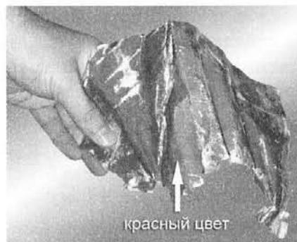
Часть обшивки самолета, одна сторона которой выкрашена в красный цвет
