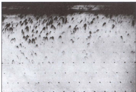
Эхограмма того же участка скопления сельди нижним эхолотом «Северянки». Каждая отметка — отражение от единичной особи. Эхолот НЭЛ-5р. Диапазон 0—100 м.
