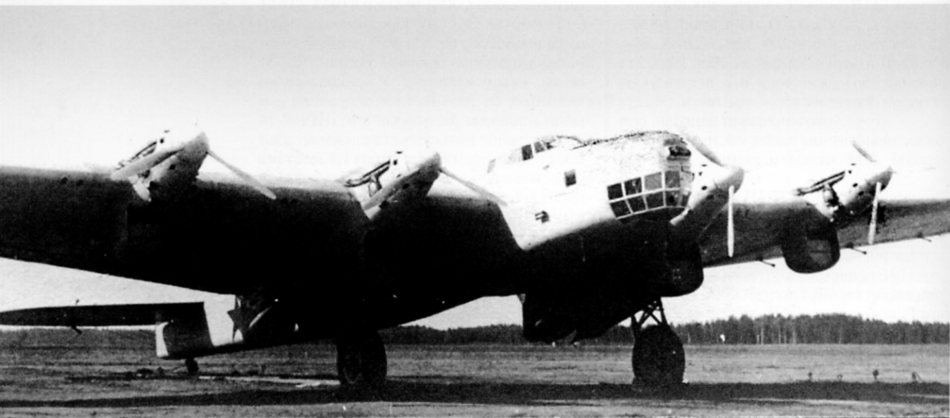
ДБ-А войсковой серии с моторами АМ-34ФРНТК
