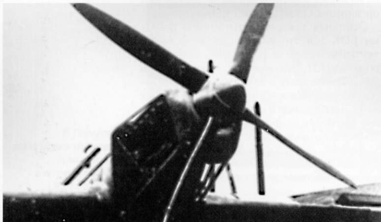
Силовая установка БОК с деревянным четырёхлопастным винтом
