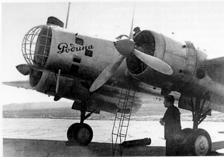
Подготовка «Родины» к полету. Над кабиной штурмана хорошо виден обтекатель антенны радиополукомпаса
