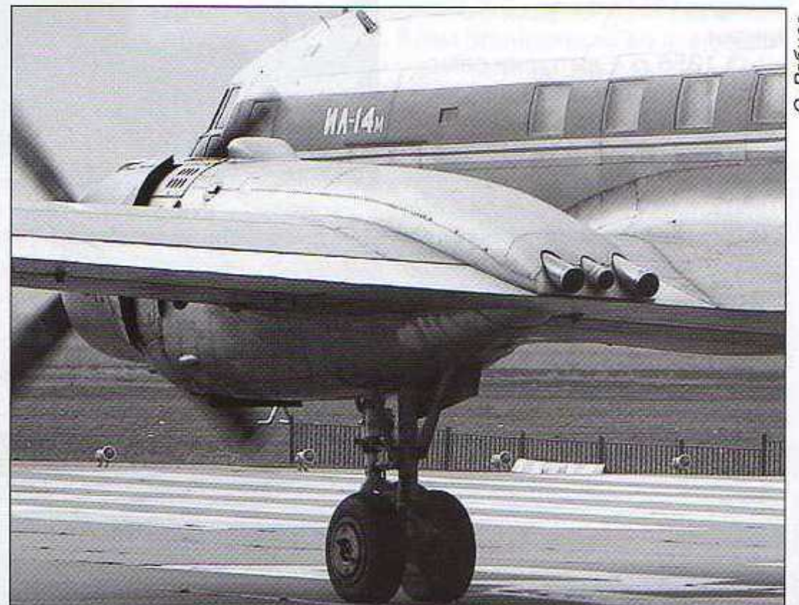
Правая и левая мотогондолы Starboard and portside engine nacelles
