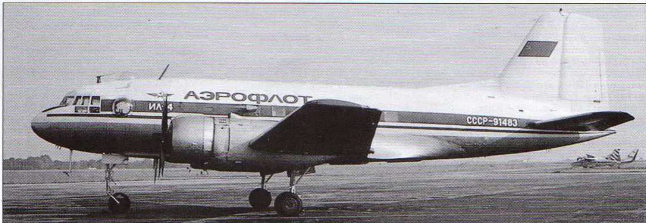
Еще один метеосамолет с характерным зондом в окне пассажирской кабины One more meteorological aircraft with characteristic probe in a window of passenger compartment
