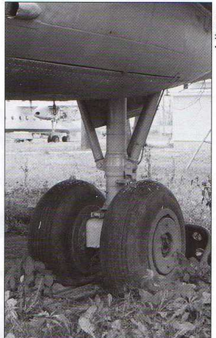
Передняя и левая основная опоры шасси
