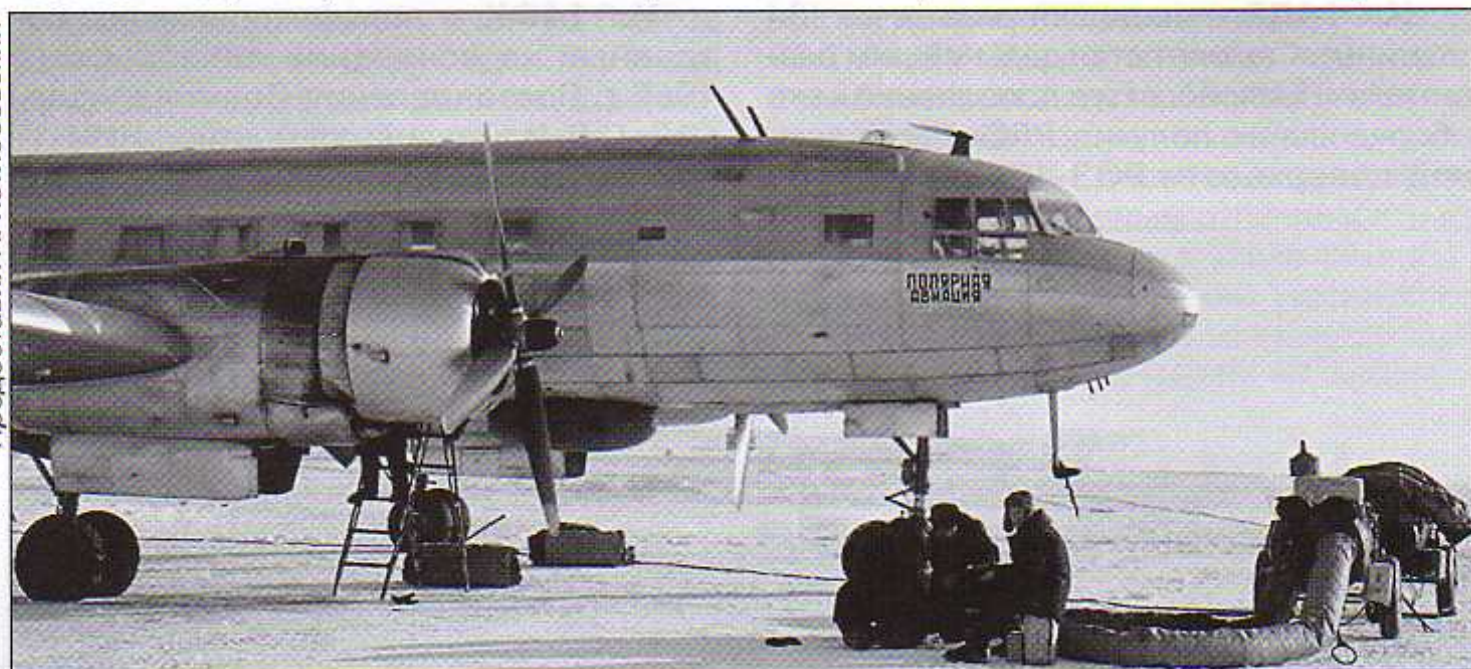
Ледовый разведчик Ил-14ЛР с характерным обтекателем РЛС The Il-14LP ice reconnaissance aircraft with characteristic radar radome
