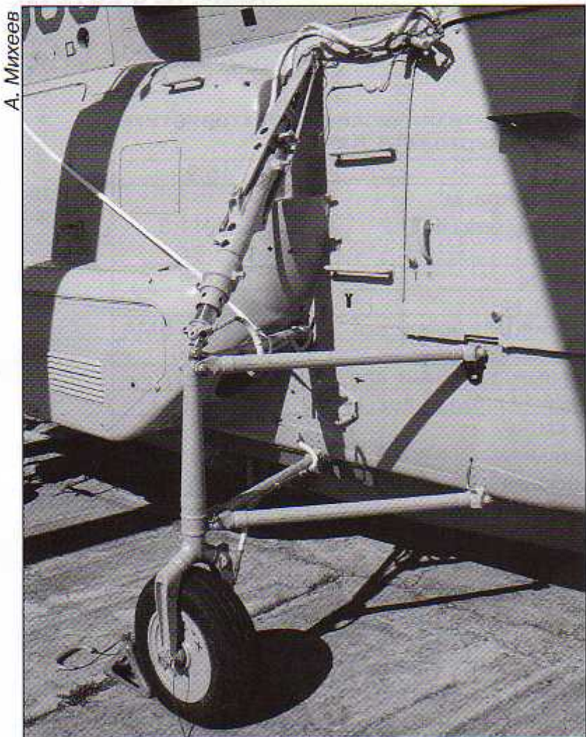
Левая основная и левая передняя опоры шасси Portside main and portside nose landing gear
