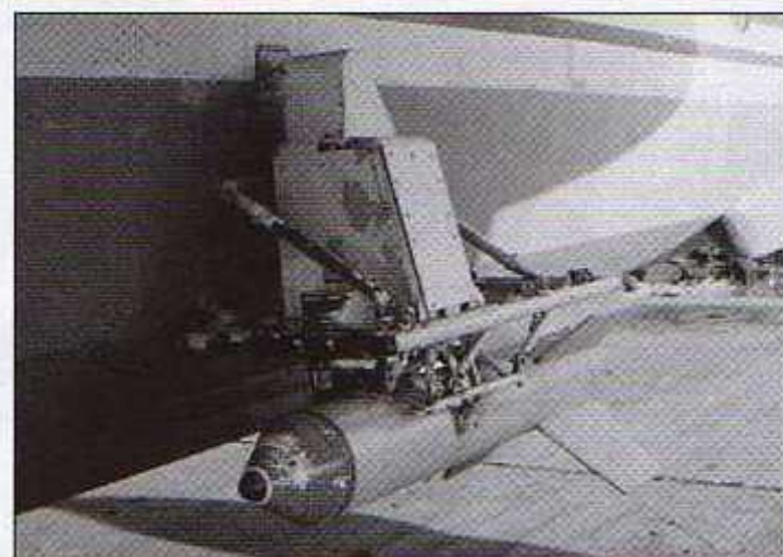
Навесное оборудование одной из метеолабораторий на базе Ил-14 Hinges equipment of a meteorological laboratory on the basis of the Il-14
