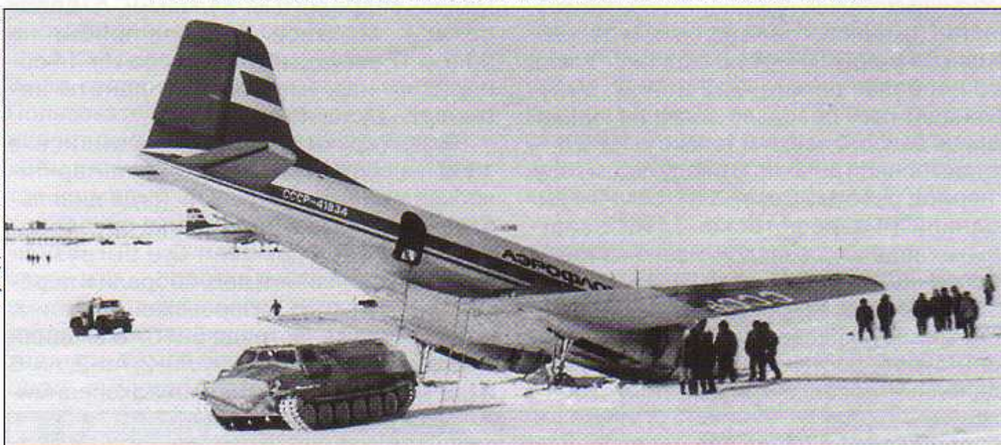
Ил-14, подломивший переднюю «ногу» на аэродроме антарктической станции Молодежная. 1970-е гг.
