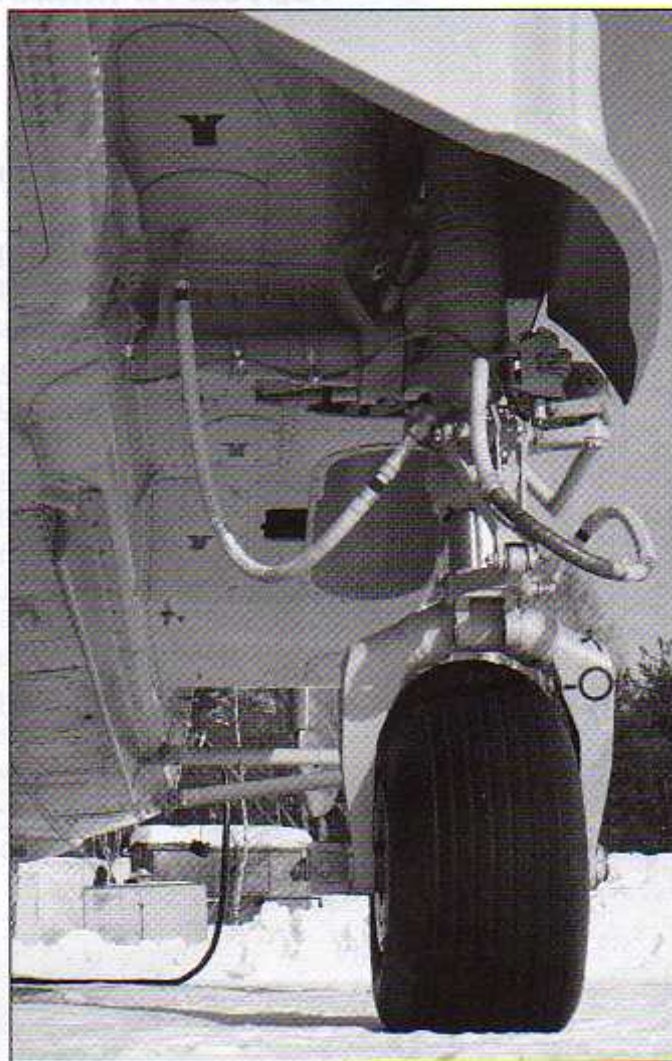
Левая основная и левая передняя опоры шасси Portside main and portside nose landing gear
