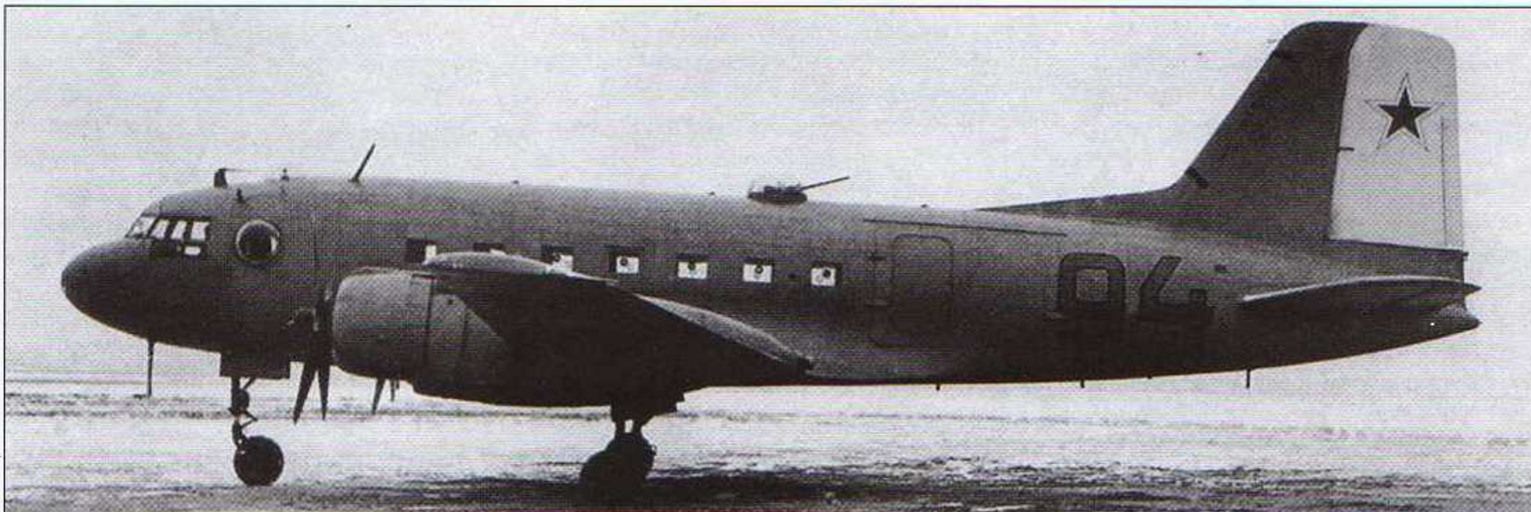
Один из прототипов военно-транспортного самолета Ил-14Т с опытной оборонительной установкой One of the Il-14T military transport prototypes with an experimental defensive plant
