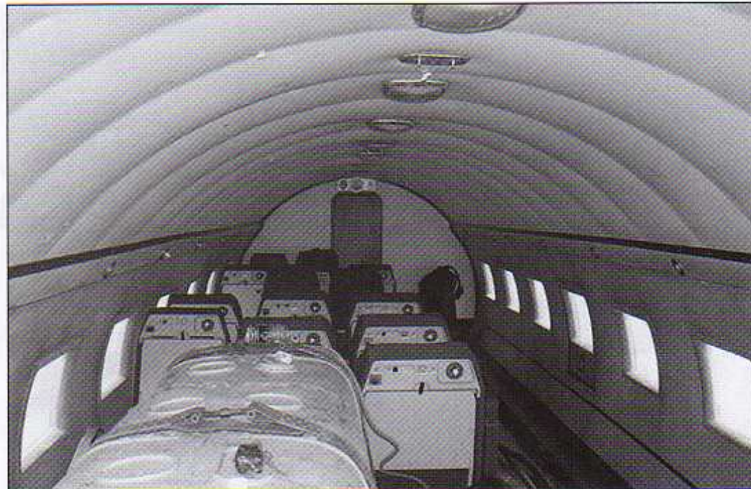
Патрульный Ил-14 Погранвойск СССР и грузо-пассажирская кабина полярного Ил-14 с дополнительным топливным баком The Il-14 patrol variant of Border Guard of USSR and passenger-cargo compartment of the Il-14 polar aircraft with external fuel tank
