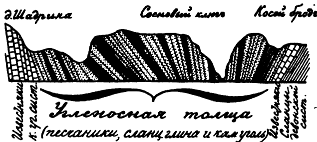
Геологическій разрѣзъ въ южной части Елбашскаго угленоснаго бассейна. (По Пету).
