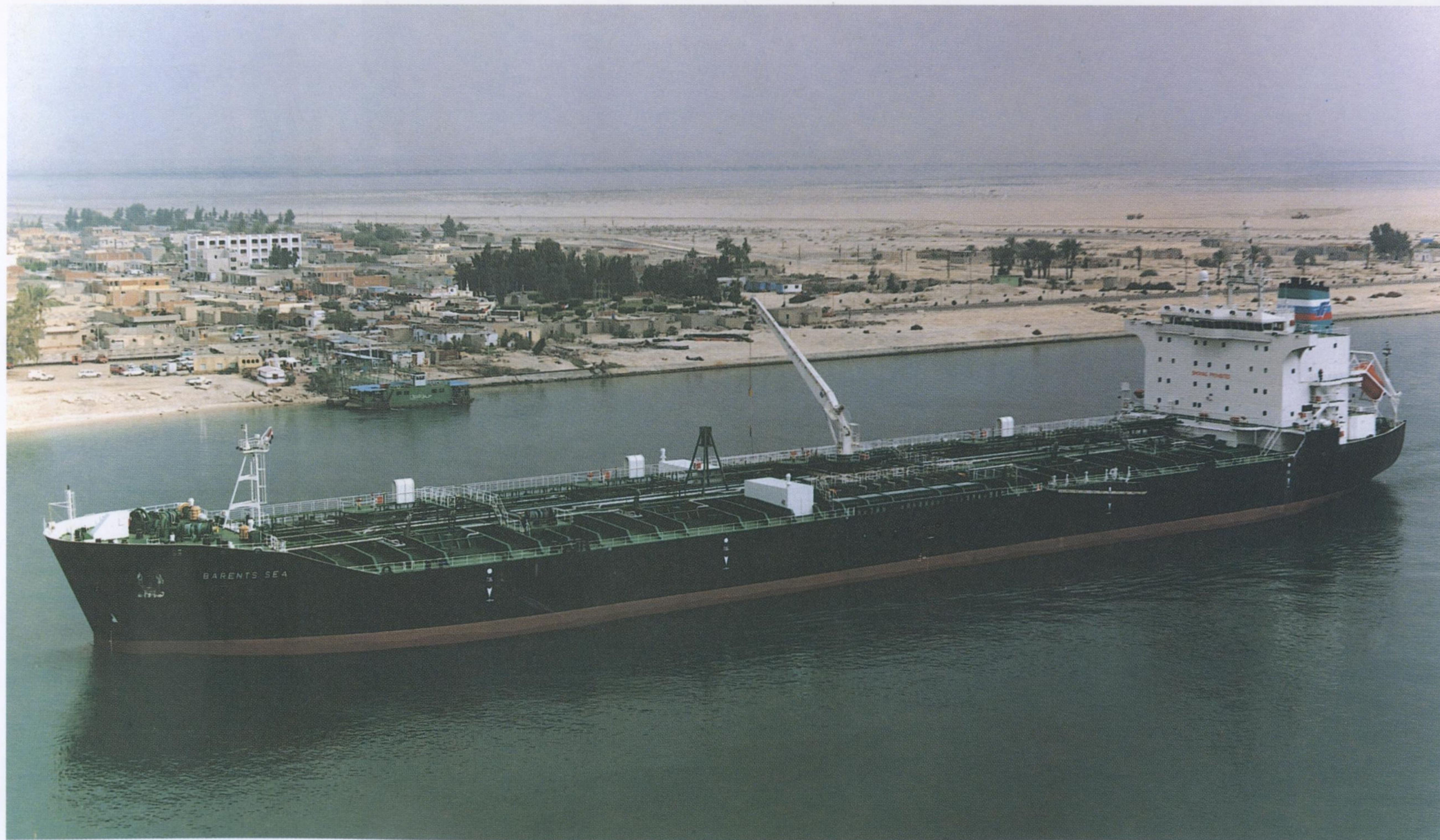
Один из 8 танкеров-продуктовозов BARENTS SEA дедвейтом 47700 тонн, построенных для «Совкомфлота» на судостроительных верфях Хорватии в 1998-99 гг. и предназначенных как для перевозки нефтепродуктов, так и широкого спектра грузов 3-го класса по классификации ИМО таких, как бензол, ксилол, толуол, гексан и др.
