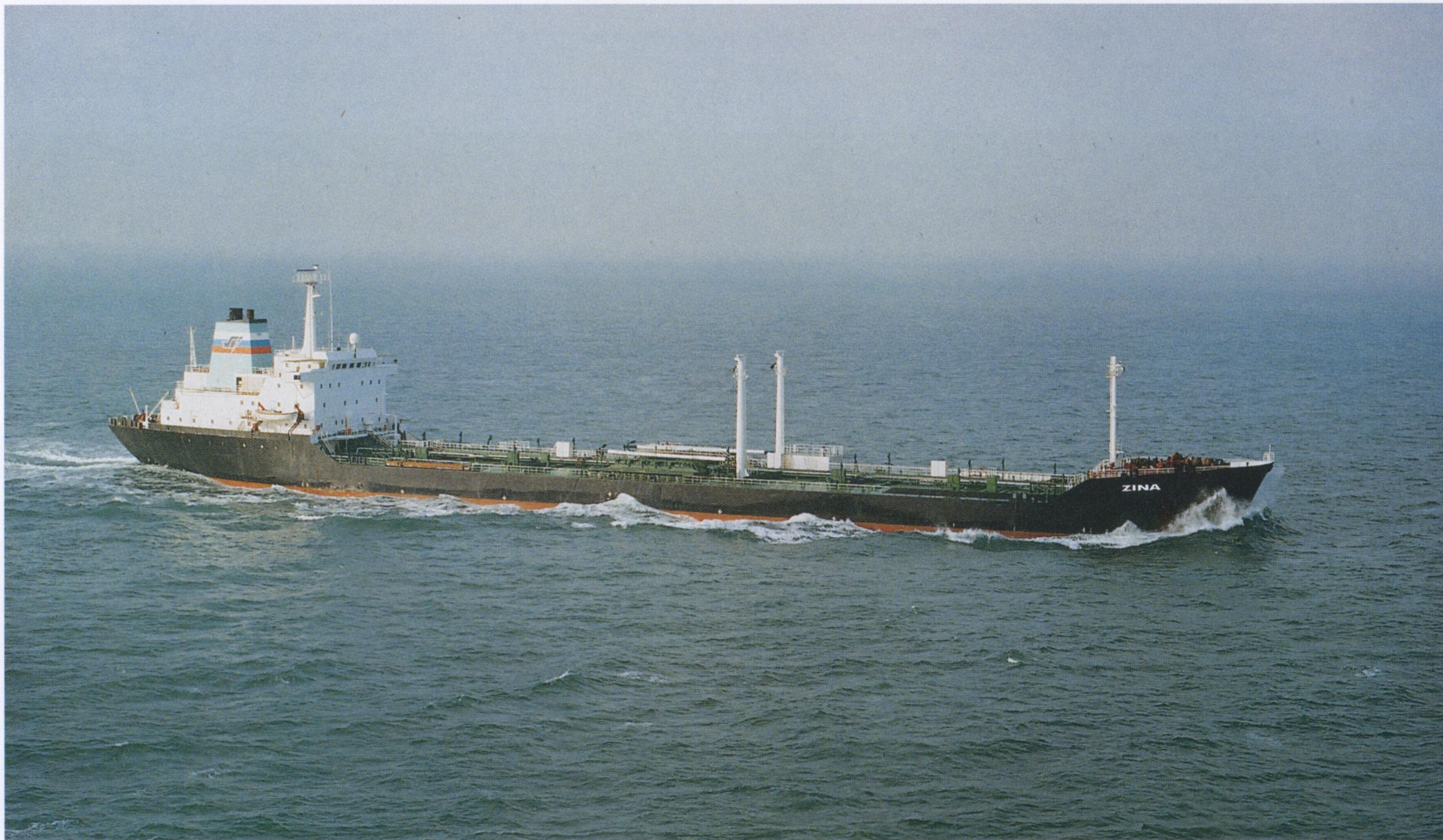
Танкер-продуктовоз ZINA дедвейтом 29490 тонн, предназначенный для перевозки нефтепродуктов. В настоящее время «Совкомфлот» имеет одно судно такого типоразмера, построенное на судовой верфи «Георгий Димитров» (Болгария, г. Варна) в 1987 г.
