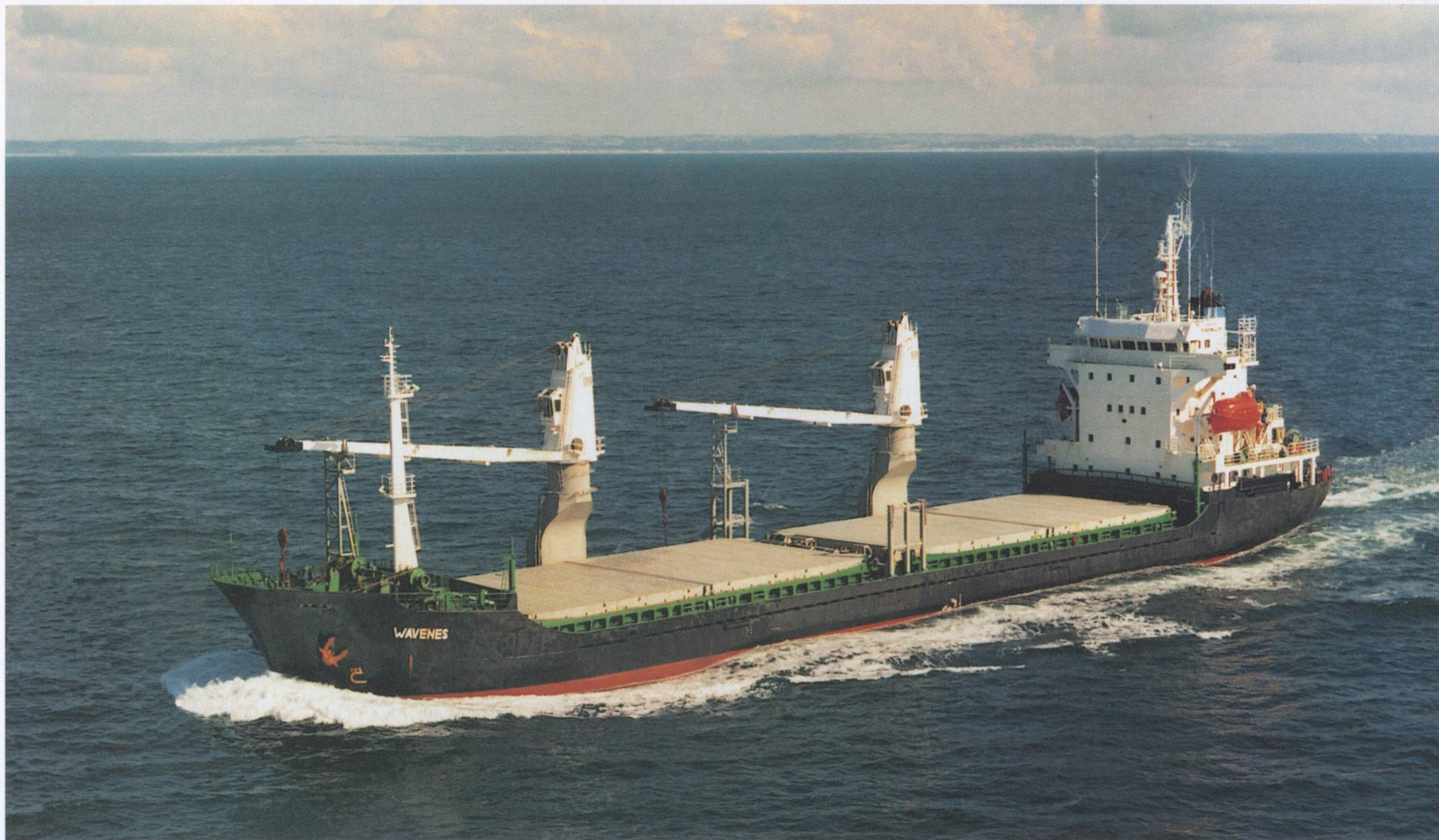
Судно-лесовоз типа SOCOFL дедвейтом 6270 тонн японской постройки, предназначенное для перевозки лесных генеральных и навалочных грузов. В составе флота СКФ имеется 10 судов такого типа. Судно построено в 1992 г. на верфи КУОКИУО (Япония)
