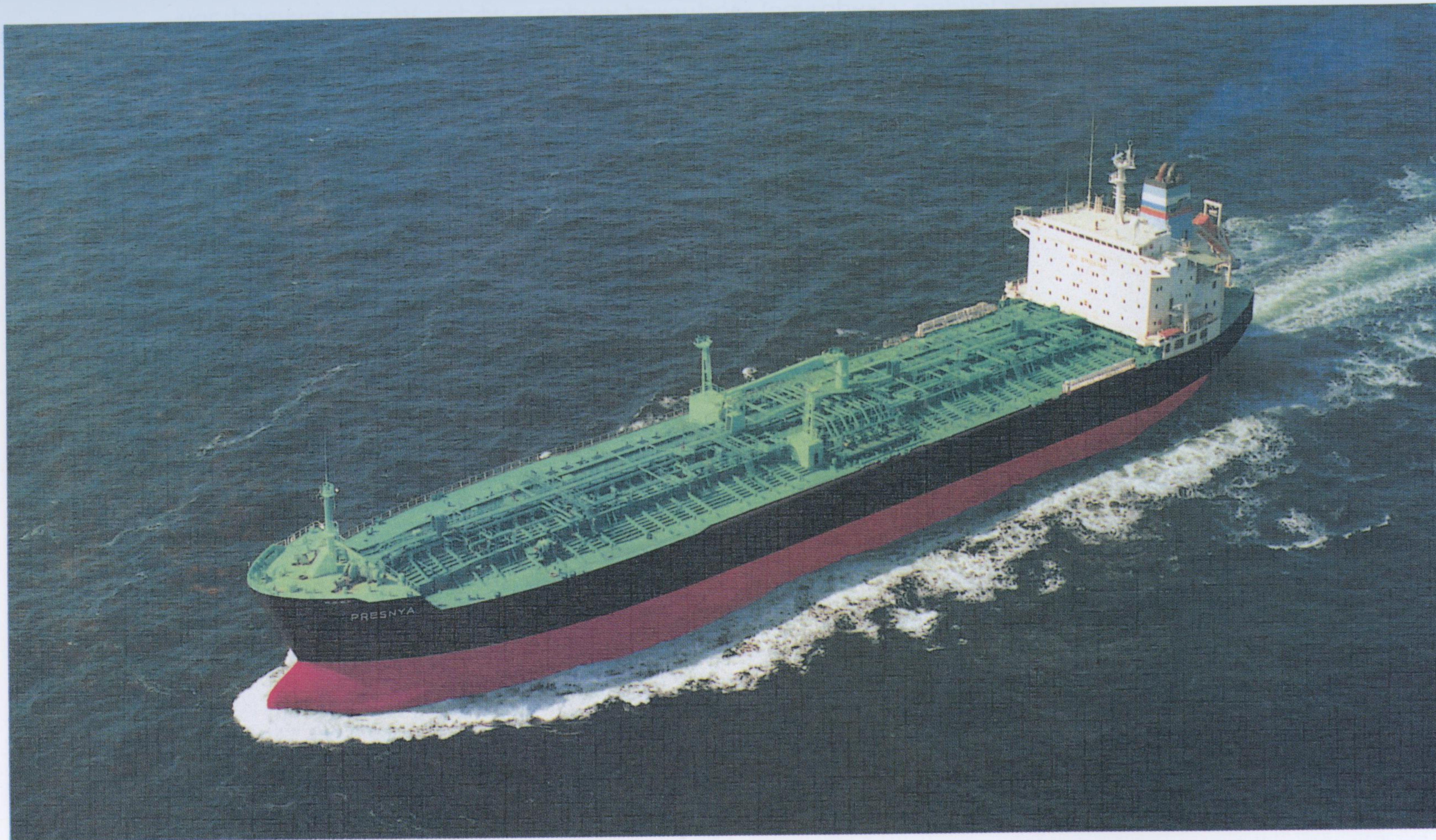
Танкер-продуктовоз PRESNYA дедвейтом 47100 тонн постройки 1991-92 гг., предназначенный для перевозки нефтепродуктов. «Совкомфлот» имеет 8 судов такого типа
