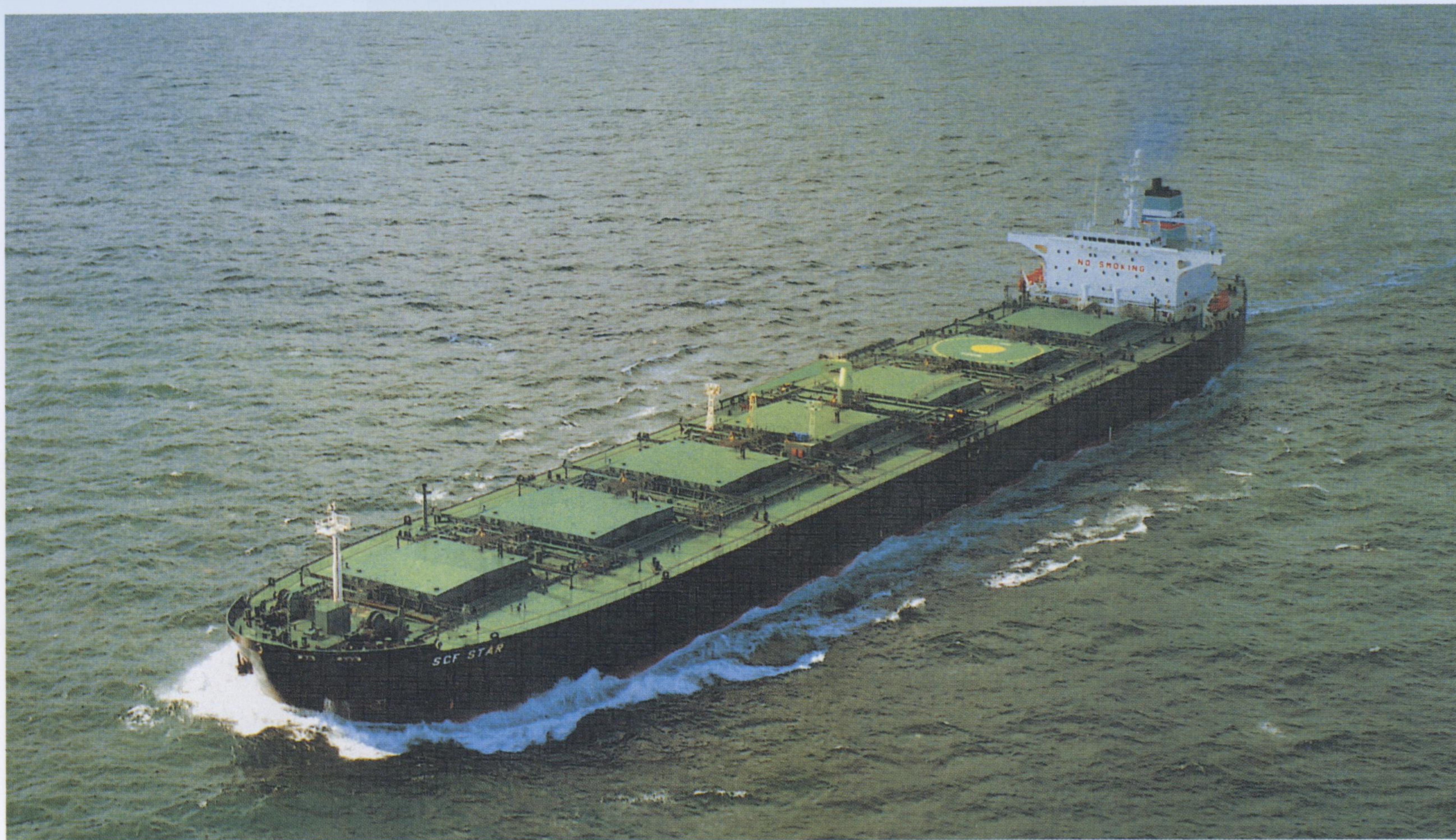
Судно ОБО SCF STAR дедвейтом 96043 тонн, предназначенное для перевозки наливных и навалочных грузов. В состав флота СКФ входят 7 судов такого типа. Суда построены в 1991-92 гг. на судовой верфи HYUNDAI (Южная Корея)
